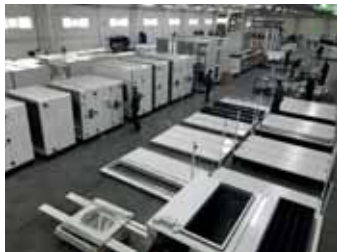
Klima Santrali Montaj Hattı
